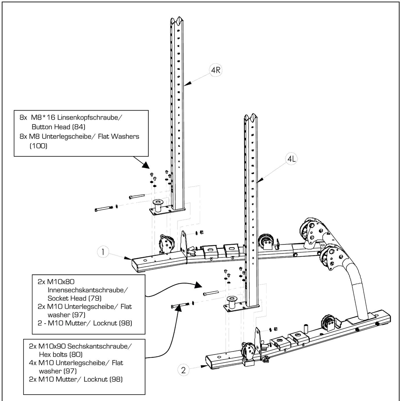
Die Schraubverbindungen werden nur handfest angezogen. In Schritt 5 werden diese dann festgezogen.
