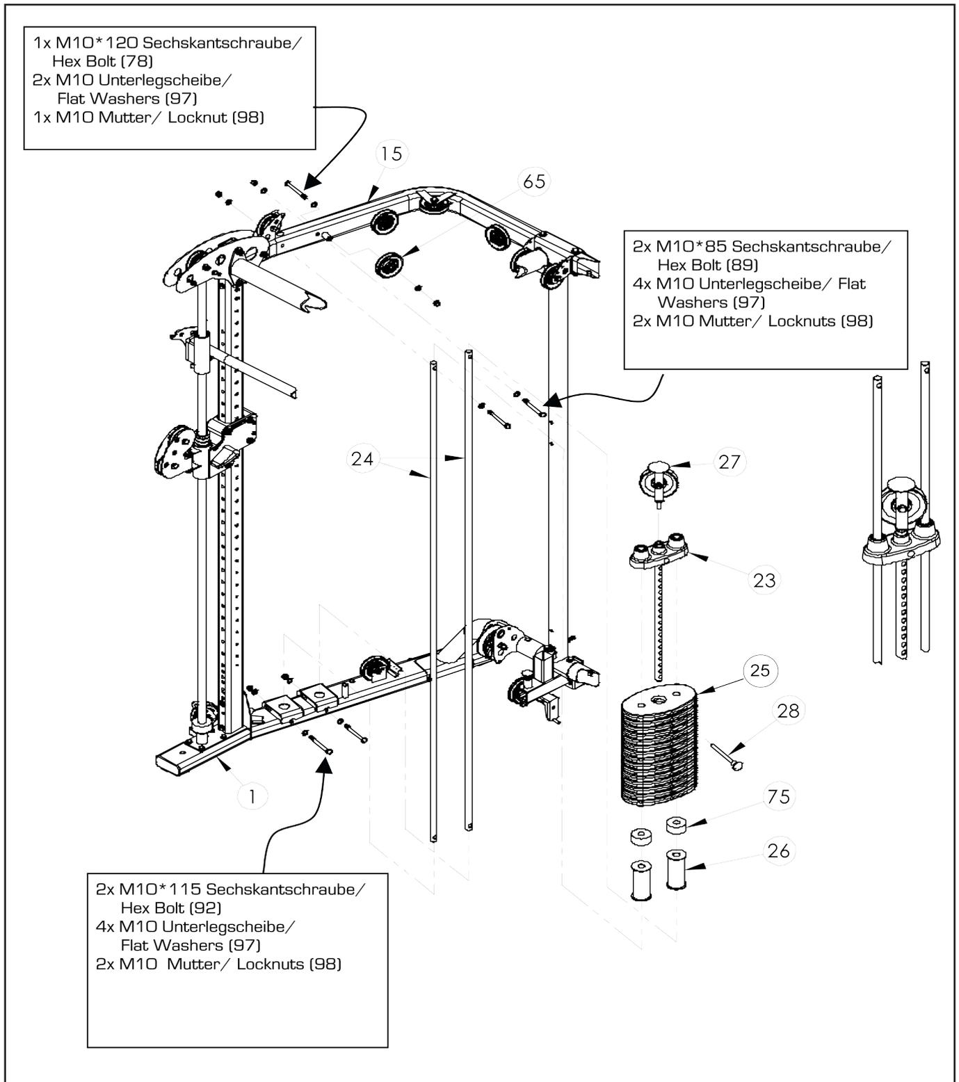
Achten Sie darauf, dass die Schrauben für die Gewichteführungsstangen von innen nach außen montiert werden!
