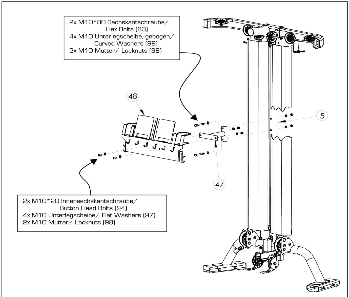
A) Befestigen Sie die Zubehörhalterung (47) in der Mitte des hinteren Rahmens (5), mit 2St. M10x80 Sechskantschrauben (83), 4St. M10 gebogene Unterlegscheibe (99) und 2St. M10 selbstsichernde Mutter (98).
