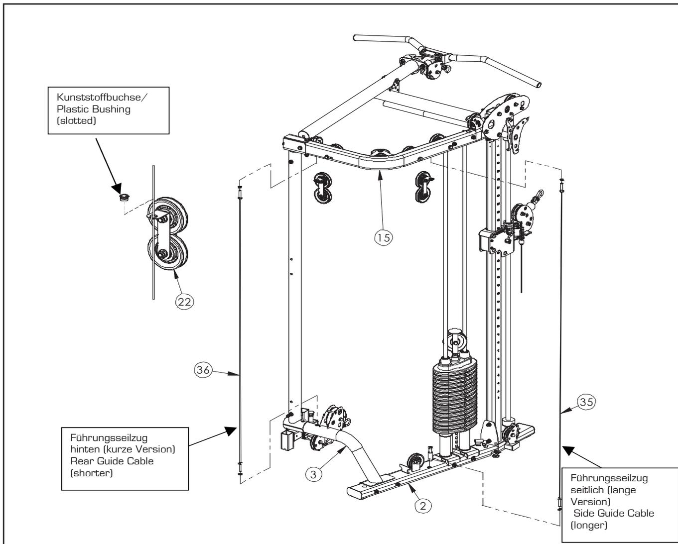
A) Drehen Sie ein Ende der langen seitlichen Seilzugführung (35) in das Gewinde am oberen rechten Rahmen(15) mit fünf Umdrehungen ein.
