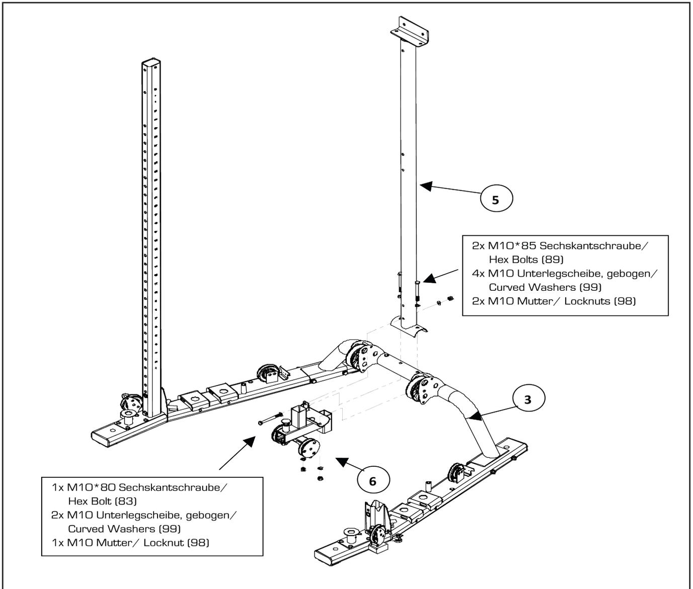
Die Schraubverbindungen werden nur handfest angezogen. In Schritt 7 werden diese dann festgezogen.
