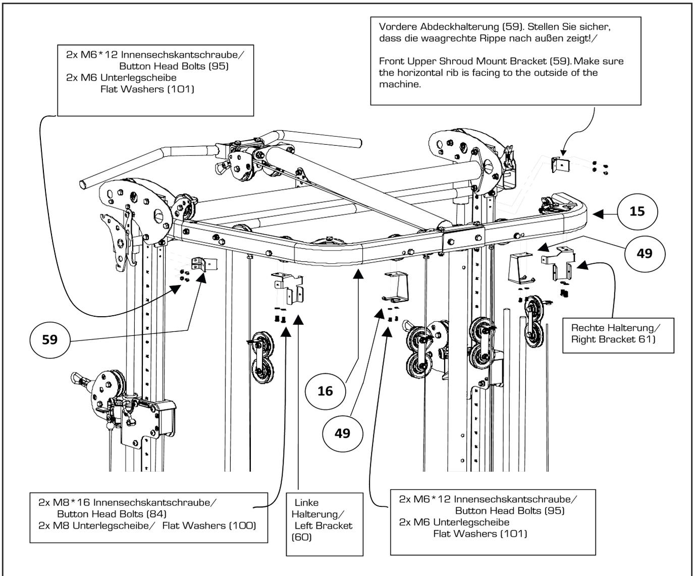
A) Montieren Sie die beiden vordere obere Verkleidungshalterungen (59) (die horizontale Verstrebung zeigt nach außen) mit je 2St. M6x12 Innensechskantschrauben (95) und 2St. M6 Unterlegscheiben (101). Schraubverbindung festziehen.
