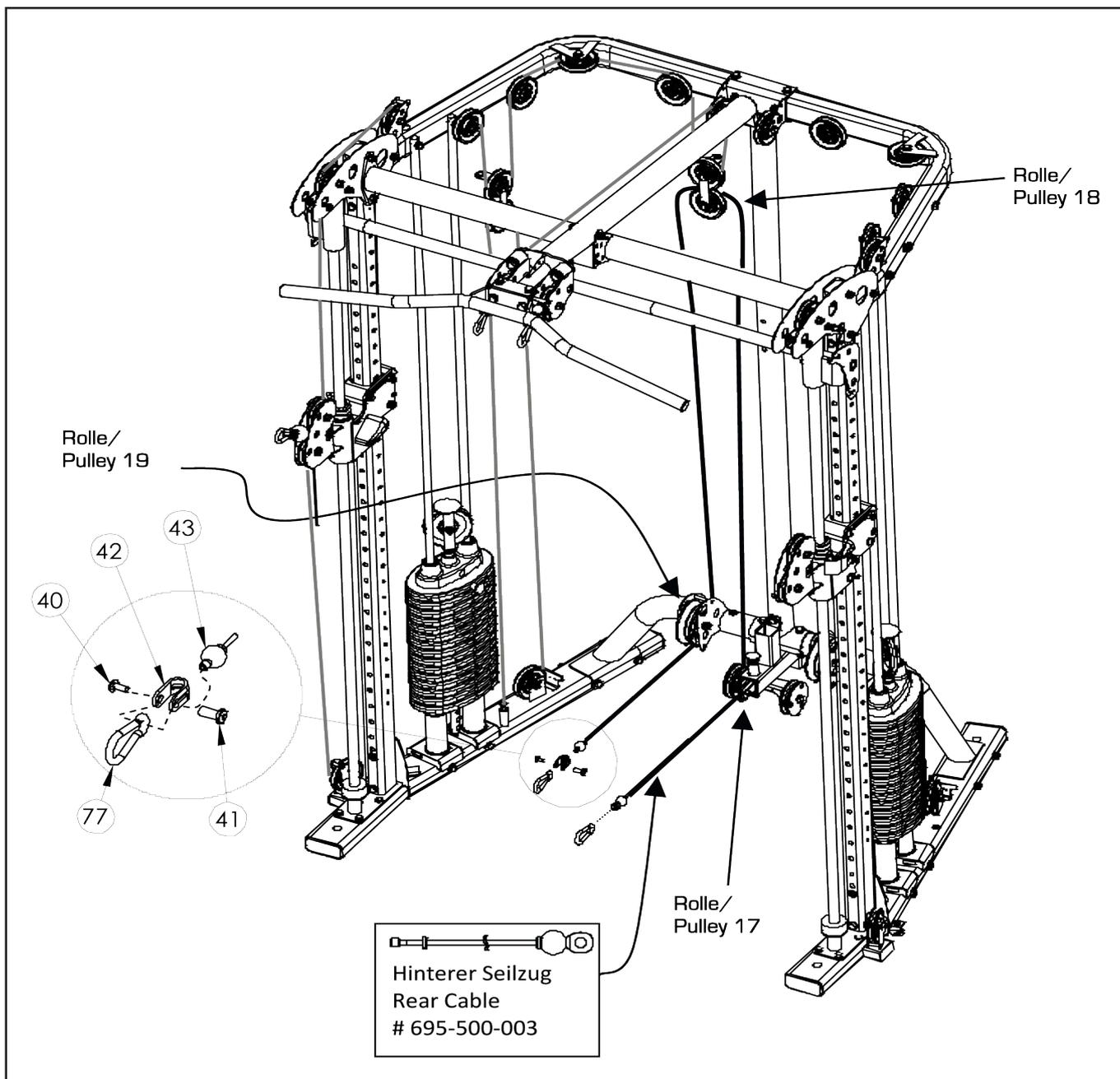
A) Führen Sie den hinteren Seilzug (34) beginnend mit dem dünnen Ende unter der Rolle 17 nach oben. Dannach über die Rolle 18 wieder nach unten und unter der Rolle 19 nach vorne.
