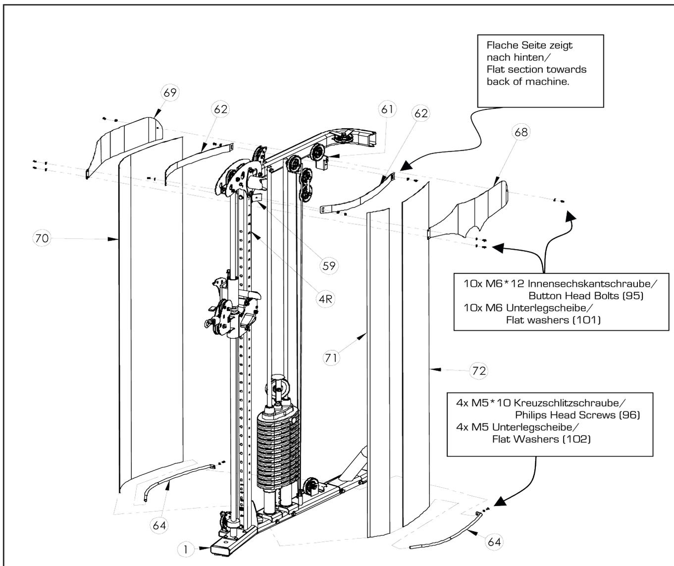
A) Drehen Sie die textile Verkleidung (70) so, dass die Naht nach innen zeigt. Führen Sie nun durch die obere Lasche die Verkleidungshalterung (62) so dass die Verkleidung nach außen gedrückt wird. Befestigen Sie die Halterung (62) an der vorderen Verkleidungshalterung (59) und am unteren Loch an der hinteren Verkleidungshalterung (61) mit 2St. M6x12 Innensechskantschrauben (95) und 2St. M6 Unterlegscheiben (101). Schraubverbindung nicht festziehen!
