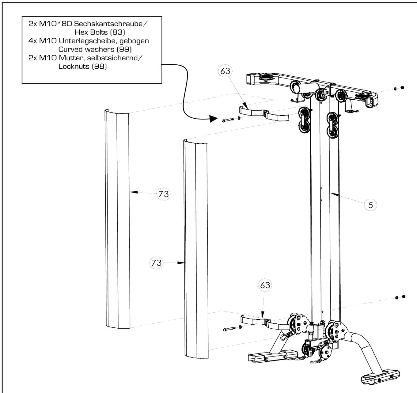
A) Befestigen Sie die hintere Verkleidungshalterung (63) oben und unten am hinteren Rahmen (5), mit 2St. M10x80 Sechskantschrauben (83), 4St. M10 gebogenen Unterlegscheiben (99) und 2St. M10 selbstsichernden Muttern (98). Die Schraubverbindung nicht festziehen
