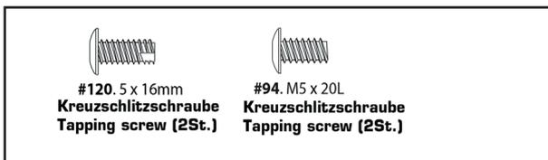
Befestigen Sie die Hauptrahmenabdeckungen (161/162) mit je einer Kreuzschlitzschraube (120) von der Rückseite und einer Kreuzschlitzschraube (94) von der Vorderseite am Hauptrahmen.
