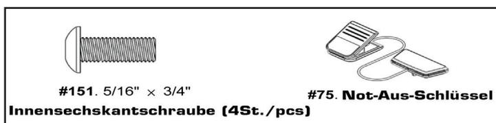
1. Befestigen Sie den Verbindungsrahmen (15) zwischen den zwei Stützen (4/5) mit vier Innensechskantschrauben (151).
