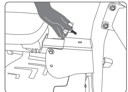
**!** Wenn der Fixierknopf an der Sitzschiene nicht richtig an der Sitzschiene einrastet, besteht Verletzungsgefahr.
