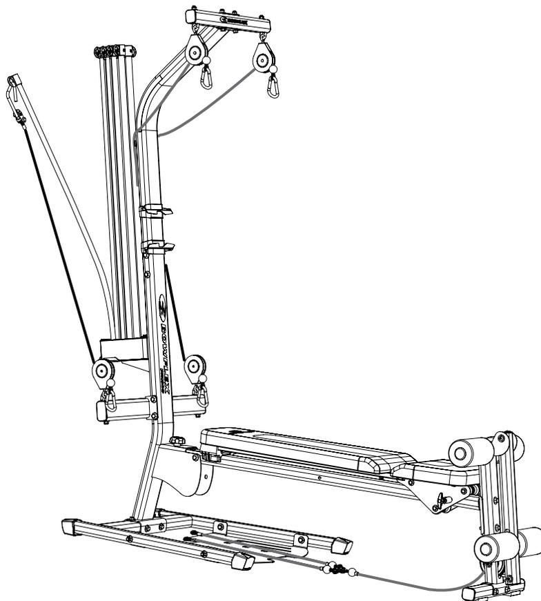
**Kabelverlauf für Querstange Lat-Einheit:**
