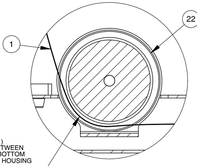
BE SURE CABLE (1) IS POSITIONED BETWEEN PULLEY (22) AND BOTTOM PLATE OF PULLEY HOUSING AS SHOWN.
