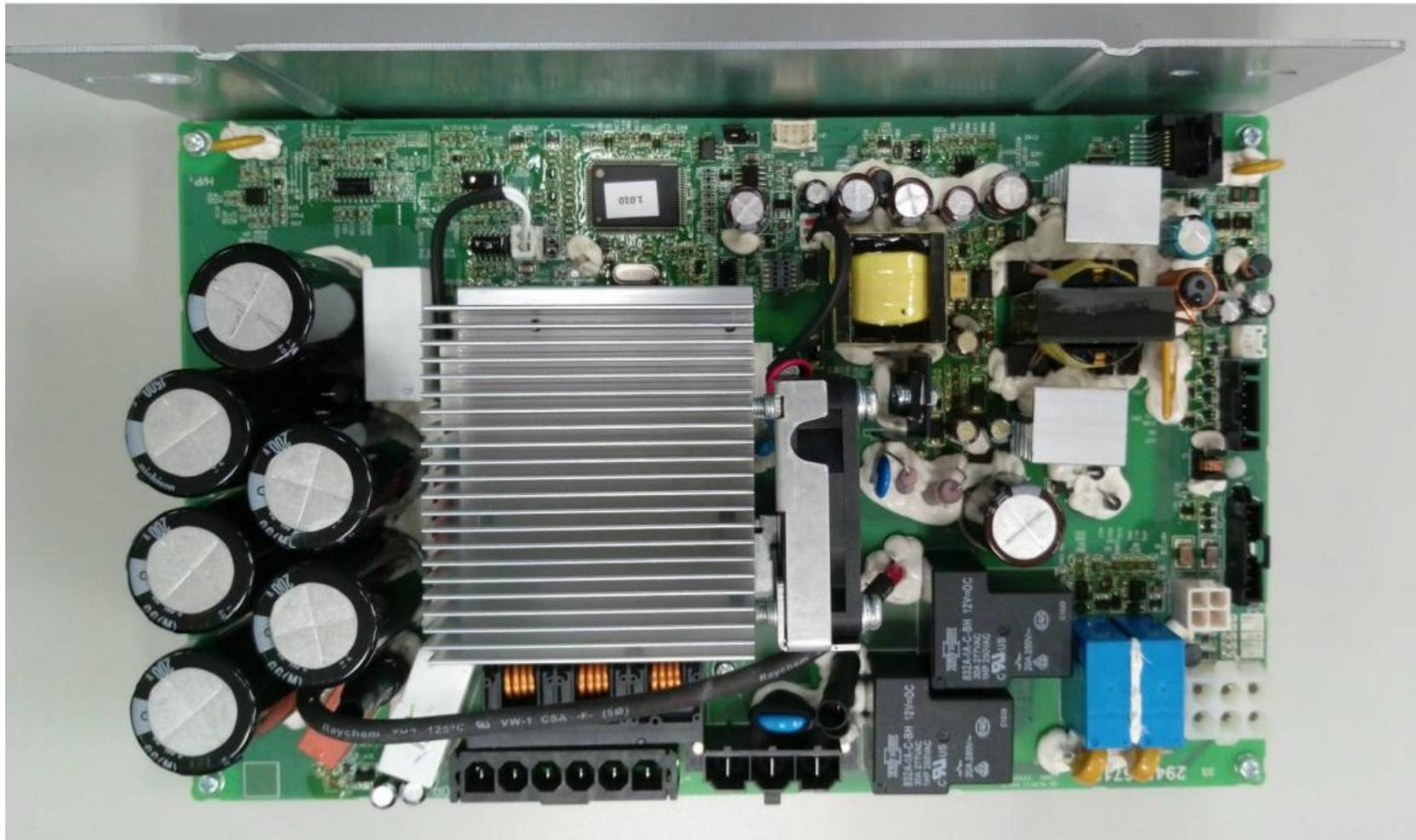
Layout der Steuerplatine (VFD015TM12A)
