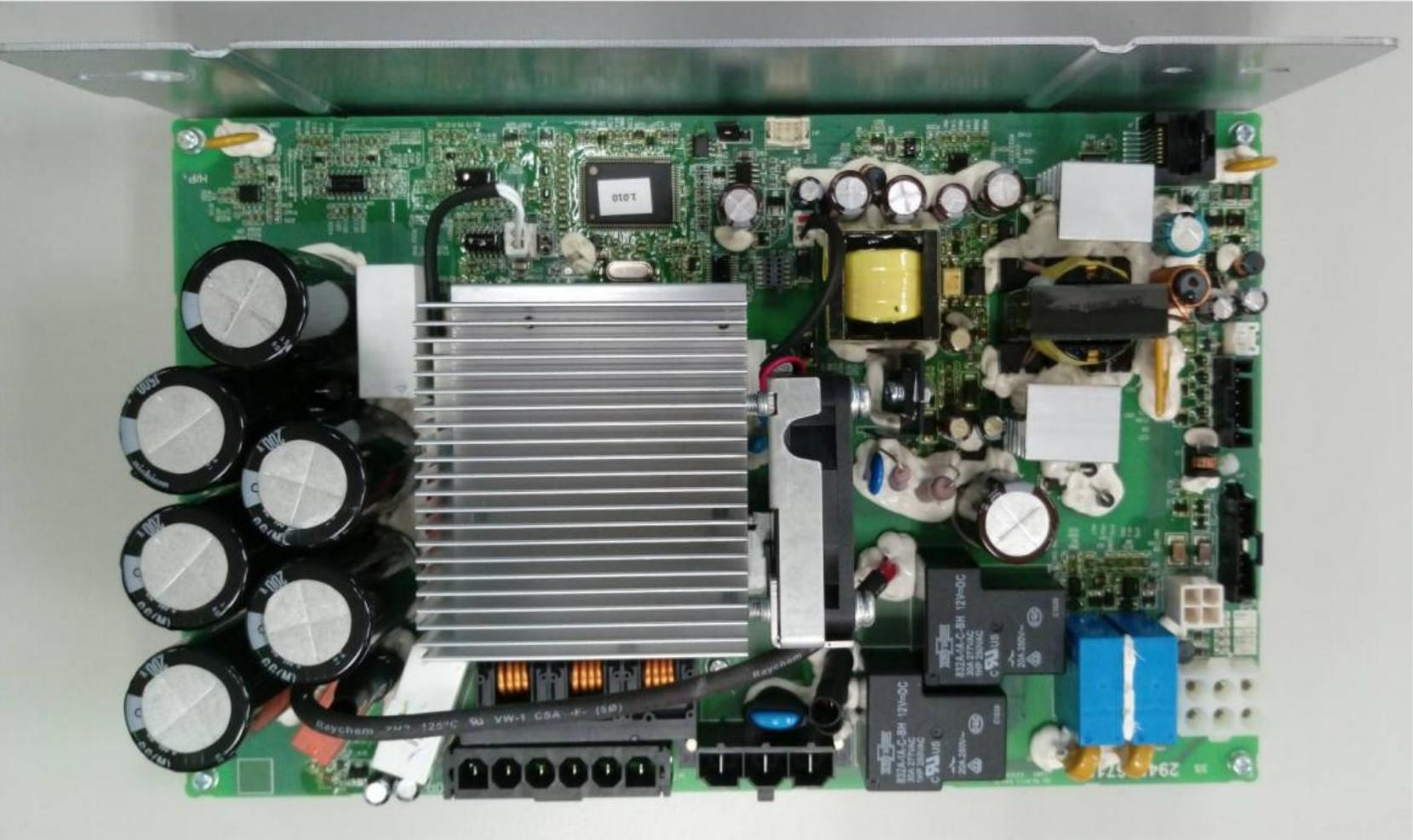
Driver PCB Board Layout (VFD015TM12A)
