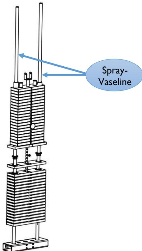
*Immagine 22. Schmieren Sie die Gleitstangen aller Pulleys*
