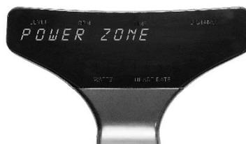
Das „POWER ZONE“- PROGRAMM zeichnet die Performance des Trainierenden anhand der Watt-Leistung in 5 Trainingszonen auf (< 55% bzw. > 106% der funktionalen Schwelle [engl. FTP – Functional Threshold Power] – siehe Erklärung hierzu im nächsten Kapitel). Der Computer verfügt über eine zusätzliche LED, die Aufschluss über die Leistung gibt. Es besteht auch die Möglichkeit einen FTP-Test durchzuführen.
