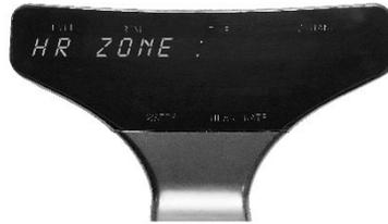
Das "HR ZONE"-PROGRAMM errechnet die ungefähre, maximale Herzfrequenz, wenn das Alter des Benutzers eingegeben wurde. Das Programm erfasst die Zeit, welche in den 5 Herzfrequenzzonen verbracht wurde (< 59% und > 91% der maximalen Herzfrequenz). Eine LED dient als zusätzliche Anzeige. Die erfasste Zeit wird jeweils in der Trainingszusammenfassung angezeigt.
