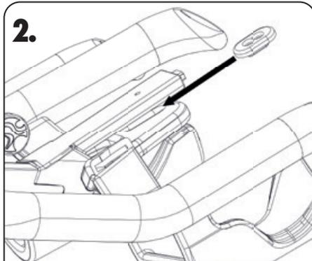
SCHIEBEN SIE DEN ABSTANDSHALTER ZWISCHEN DEN LENKERN UND DIE COMPUTERHALTERUNG. DER ABSTANDSHALTER PASST GENAU IN DIE NUT AM LENKER.
