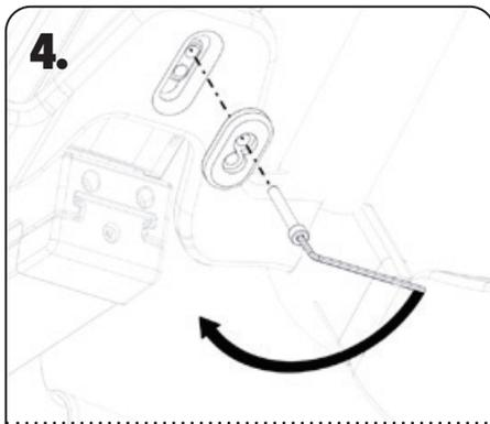
BEFESTIGEN SIE DEN ZWEITEN ABSTANDSHALTER AN DER AUSSENSEITE DES LENKERS MIT DER MITGELIEFERTEN SCHRAUBE UND EINEM 3MM INBUSSCHLÜSSEL.
