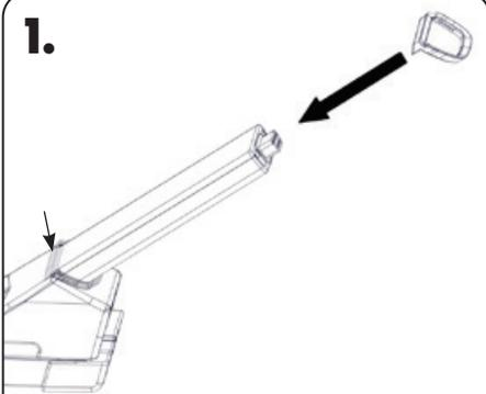
SCHIEBEN SIE DIE DICHTUNG AN DAS UNTERE ENDE DER COMPUTERHALTERUNG.
