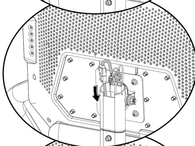
d. Schieben Sie die Stecker und Kabel vorsichtig in die Konsolenstange. Achten Sie auf folgende Reihenfolge:
