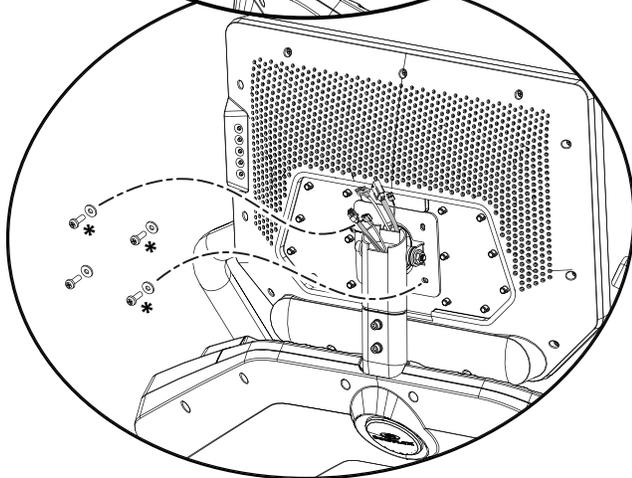
b. Drehen Sie die Konsole nach unten und befestigen Sie sie an der Konsolenstange.
