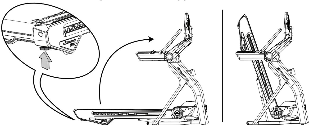
**!** Heben Sie das Band nicht am Band oder den hinteren Rollen an. Diese Teile rasten nicht ein und können sich plötzlich bewegen. Es kann zu Verletzungen oder zu Schäden am Gerät kommen.
