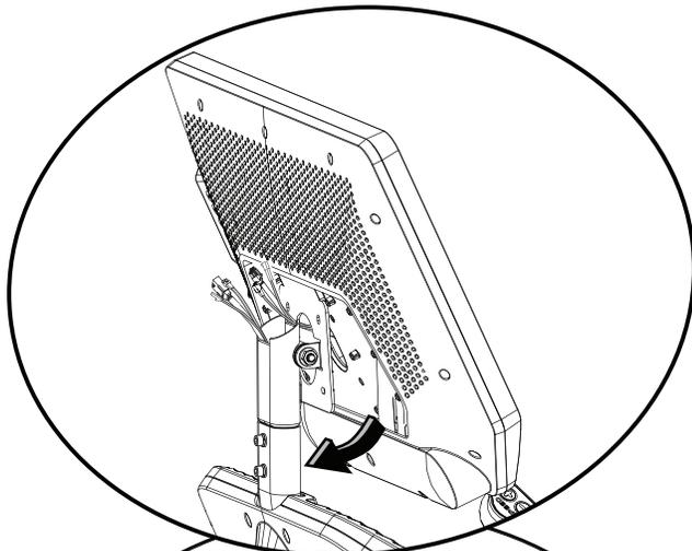
a. Setzen Sie die Konsole auf die Konsolenstange und führen Sie die Kabel durch die Stange und wieder heraus.
