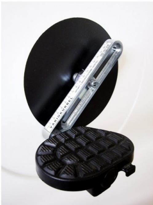
Bras de pédale avec rayon de manivelle réglable pour ergomètres et vélos d'appartement. La manivelle Vario est une manivelle de pédalier réglable en longueur pour les vélos ergomètres et les vélos d'appartement. Les patients dont la capacité de flexion des articulations de la hanche et du genou est réduite peuvent déterminer leur angle de flexion personnel en ajustant la longueur de la manivelle, ce qui leur permet de se rapprocher plus tôt de la mobilisation.
